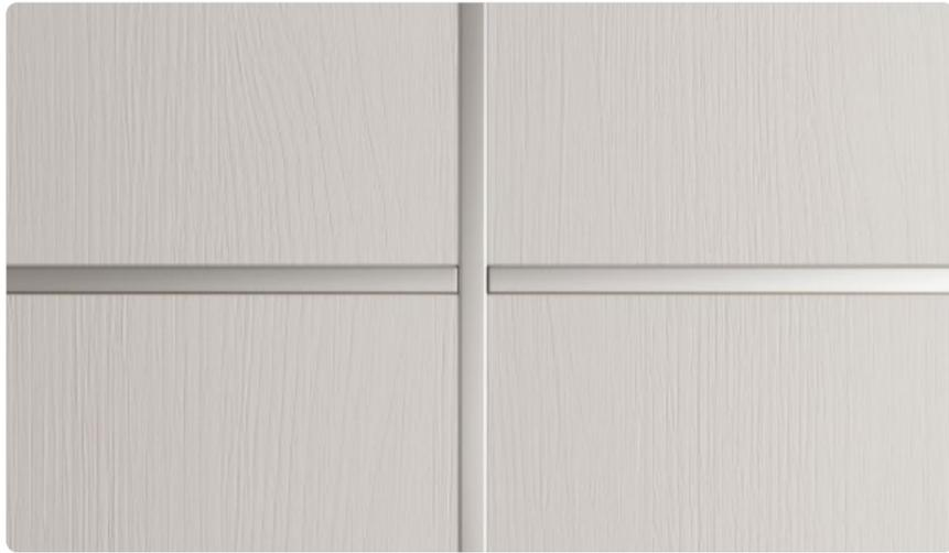
В таком варианте соединения панели устанавливаются с помощью декоративного алюминиевого профиля. Видимая часть профиля — 6 мм. Алюминиевый профиль может быть окрашен в любой цвет по каталогам RAL и NCS.
